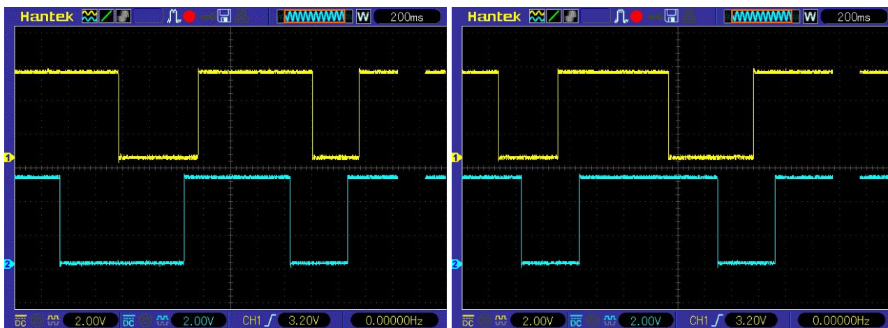
Рисунок 4. Слева осциллограмма вращения по часовой стрелке, справа осциллограмма вращения против часовой стрелки
