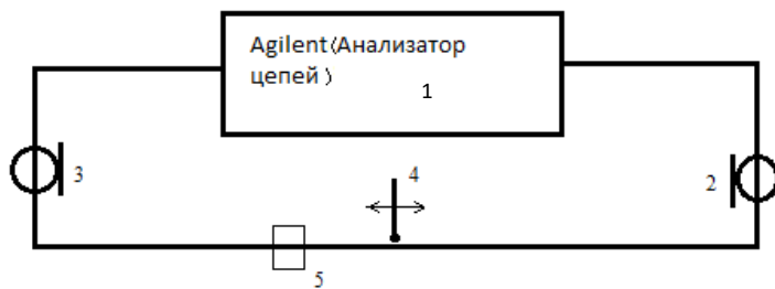
Рис 3.2. Измерительная схема:1 –Анализатор цепей 2,3- Коаксиальные волноводы, 4-подвижный зонд,5- измерительный призматический резонатор
