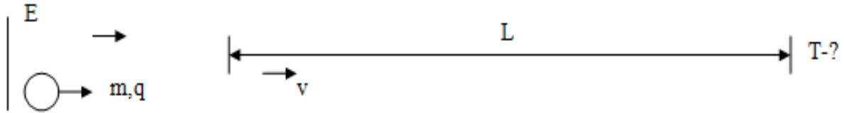
Рис. 1. Принцип работы времяпролётного масс-спектрометра
