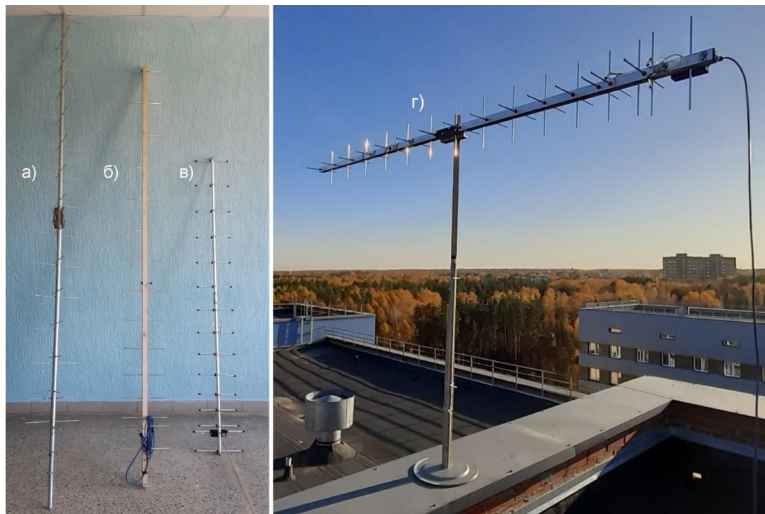
Рис. 4 Внешний вид антенн, имеющихся в наличии, а) антенна производства Ну-Gain (США), б) самодельная антенна, в) антенна производства Diamond (Япония), г) итоговый вариант самодельной антенны для круговой поляризации.
