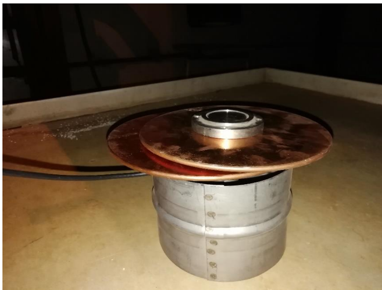
Рис. 4 Диод, помещенный под пучок с защитой от быстрых и вторичных электронов
