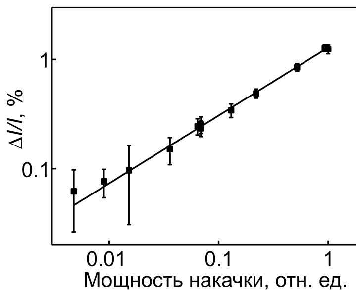
Рис.5. Зависимость величины модуляции фототока, нормированной на величину фототока, от мощности лазерной накачки
