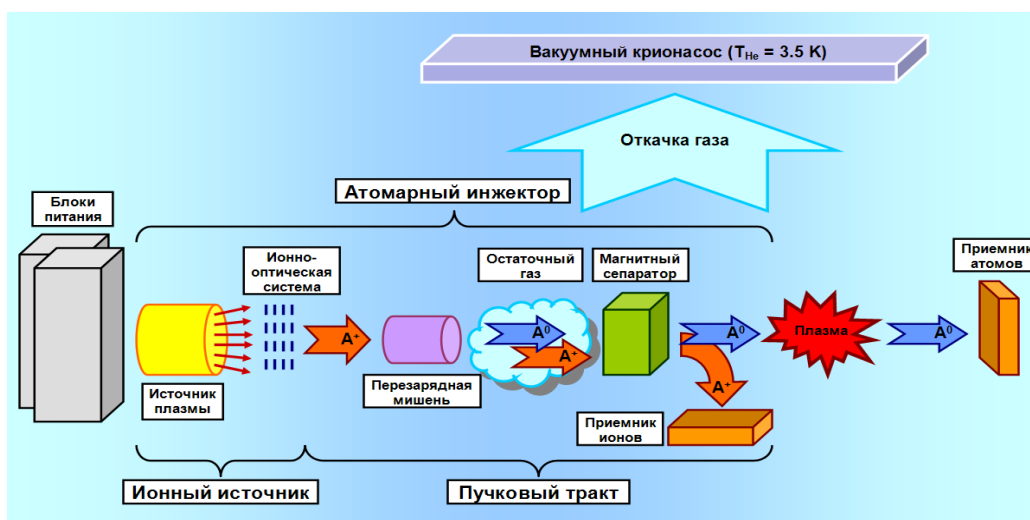
Рис. 1. Схема получения и инжекции нейтрального пучка.
