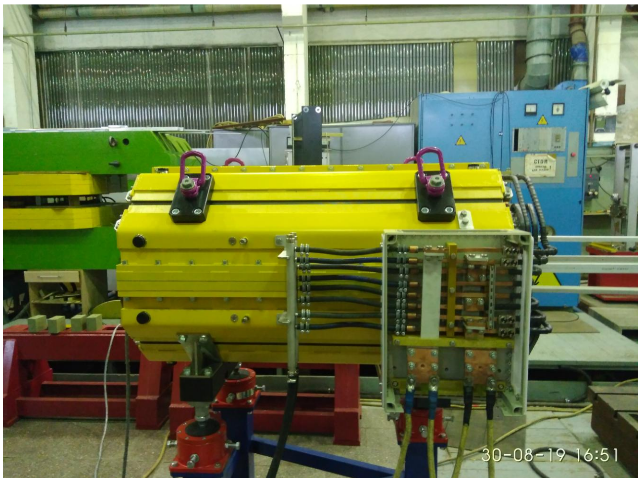
Рисунок 1. Магнитный квадруполь QP11 G_n=100 T/m (контракт FAIR HEBT)
