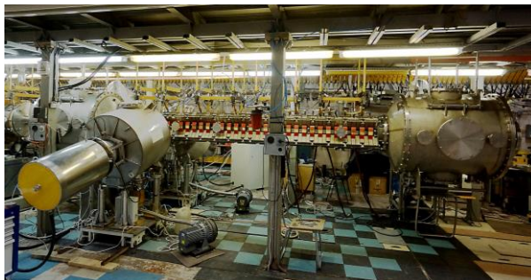
Рис. 1. Схема и фотография стартовой конфигурации установки ГОЛ-NB: 1 – бак расширителя магнитного потока с плазменной пушкой; 2 – модуль системы вакуумной откачки; 3 и 6 – секции сильного поля; 4 – инжекторы атомарных пучков водорода; 5 – секция для присоединения инжекторов; 7 – бак выходного расширителя магнитного потока с плазмоприемником. Расстояние между колоннами 3 м
