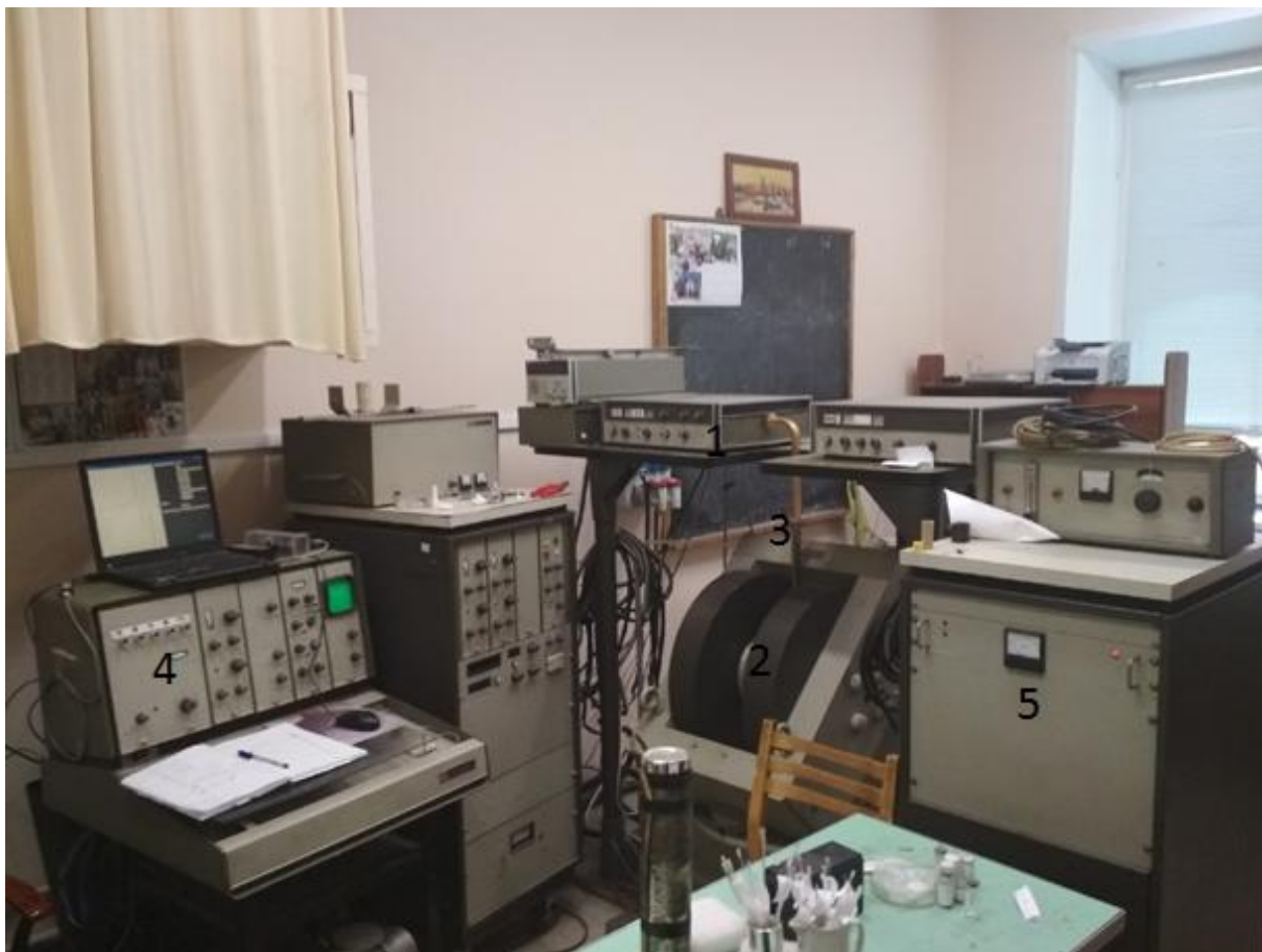
Рис. 3. Общий вид ЭПР – спектрометра Varian E109. 1-Блок СВЧ генератора; 2- магнит; 3- резонатор с волноводным трактом; 4-Блок управления спектрометром и регистрации спектров; 5-Блок питания.
