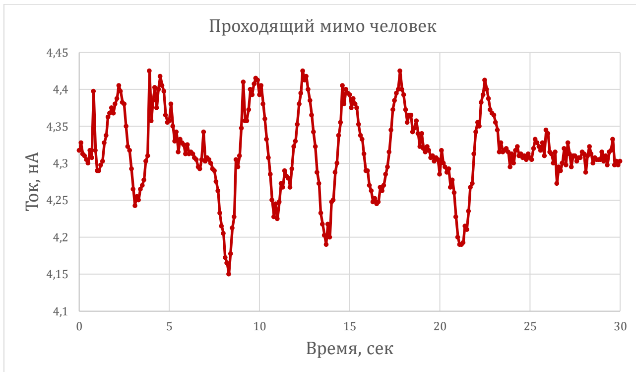
Рис. 7 Реакция датчика на проходящего человека
