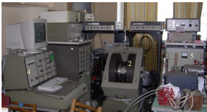
Рис. 4. Общий вид ЭПР – спектрометра Varian E109. 1-Блок СВЧ генератора-; 2- магнит; 3- резонатор с волноводным трактом; 4-Блок управления спектрометром и регистрации спектров; 5-Блок питания.
