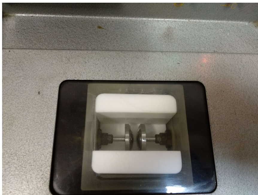
Рис. 3. Измерительная ячейка с полусферическими электродами.
