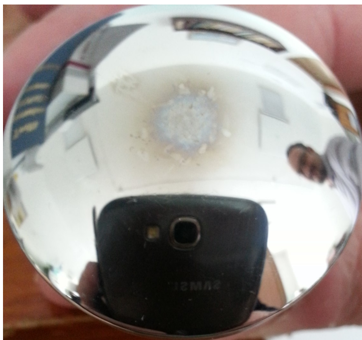
Рис. 4. Фотография полированного полусферического электрода после 60 пробоев в ПФДБЭ. Диаметр электрода 34.2 мм.
