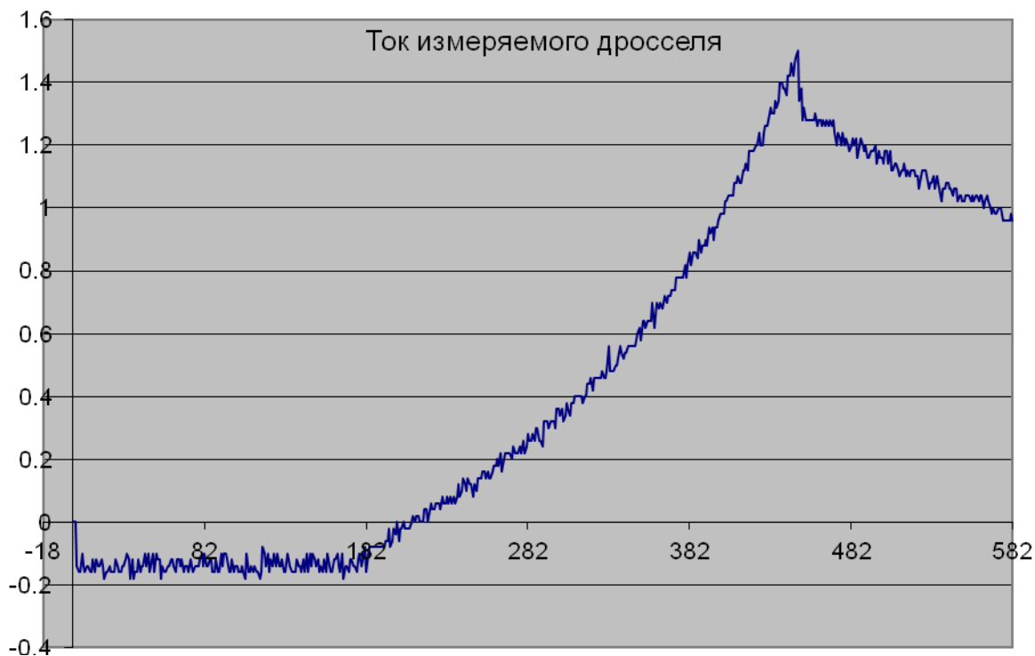
Рисунок 6. График зависимости напряжения от времени на измеряемом дросселе
