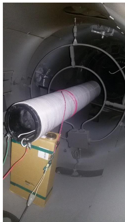
Рисунок 5. Экспериментальная установка для калибровки петли.
