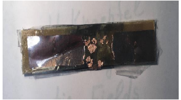
Рисунок 7. Образец расплавившегося проводника.
