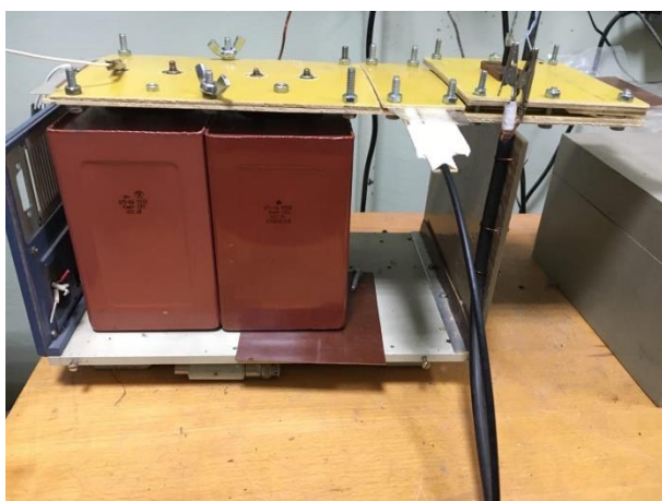
Рисунок 2. Экспериментальная установка с конденсаторными батареями, установленным индуктивным датчиком внутри полосковой линии.
