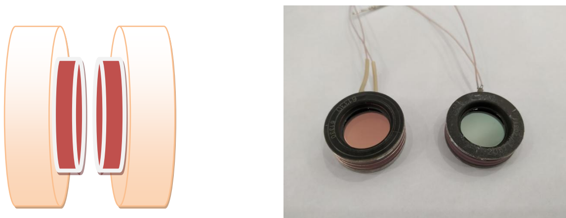
Рис. 6. Устройство используемого вакуумного фотодиода
