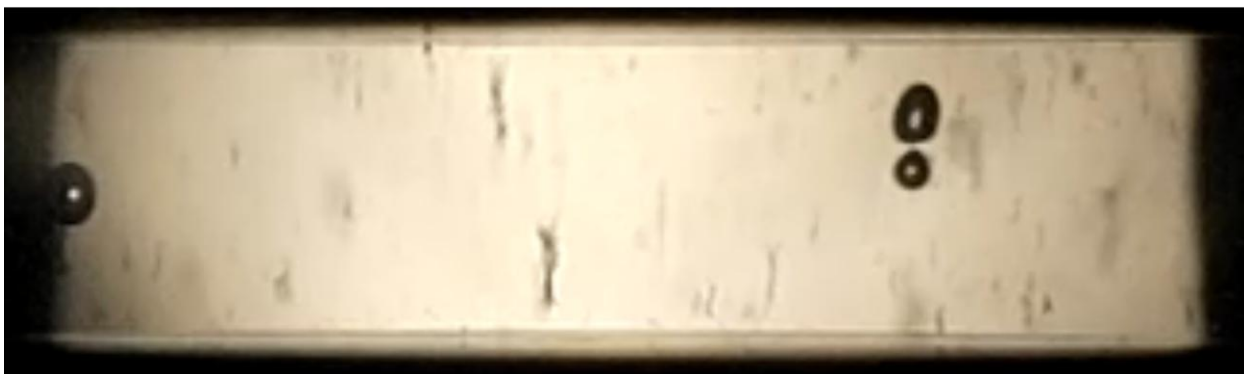
Рис. 12. Напряжение 12 кВ, разрыв пузырька после ЧР.
