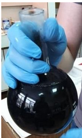
Рис. 6. Раствор нанотрубок перемешанный магнитной мешалкой.
