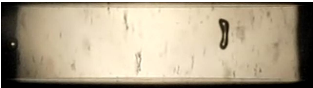
Рис. 11. Напряжение 12 кВ, изменение формы пузырька после ЧР.
