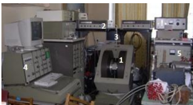
Рис.5. Спектрометр E109. 1 – магнит; 2 – блок СВЧ генератора; 3 – резонатор с волновым трактом; 4 – блок управления спектрометром и регистрации спектров; 5 – блок питания
